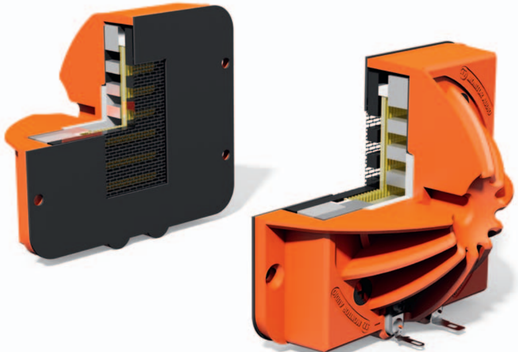
Micro Pleated Diaphragm (Mikrofaltenmembran) nennt Monitor Audio den neu entwickelten Air-Motion-Transformer, der den Bändchen-Hochtöner aus der ursprünglichen Serie ablöst. Er hat eine deutlich größere Oberfläche als gängige Hochtonkalotten und ist daher wesentlich effizienter, auf der anderen Seite aber auch deutlich klirrärmer.
