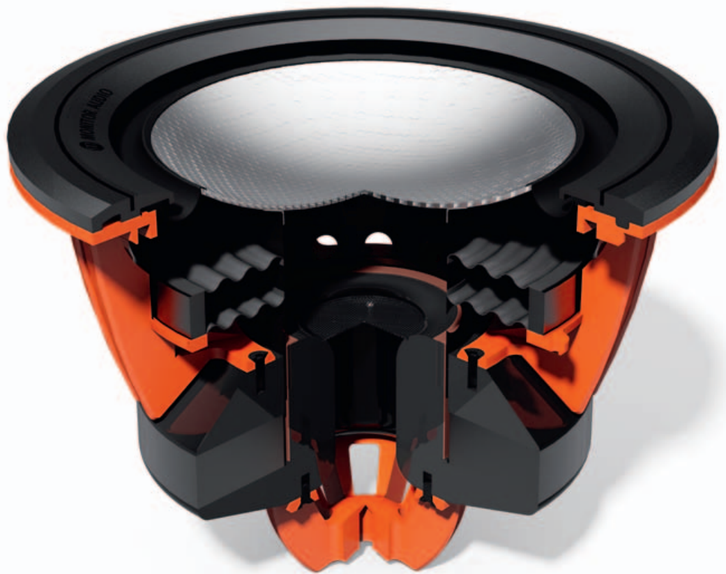
Das Schnittbild zeigt den Aufbau des Basstreibers. Er arbeitet mit einer Unterhangspule, eine optimierte Wärmeableitung verringert die Kompression und erhöht die Effizienz. Die mehrschichtige Membran besteht aus einem wabenförmigen Nomex-Skelett, die einen Belag aus Aluminium-Magnesium-Legierung trägt, und auf der Rückseite mit einem Kohlefasergewebe bedämpft ist.
